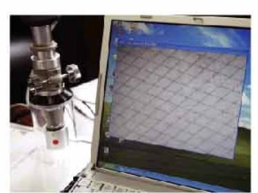
マイクロスコープでしか見えない5ミクロンレベルの線。微細な模様を描ける技術と印刷メッキ技術で平面アンテナを印刷
