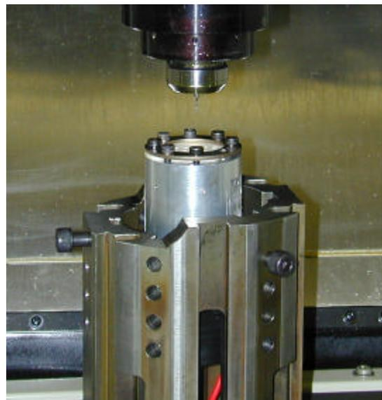
Fig.1 被削材に振動を付加する実験装置
