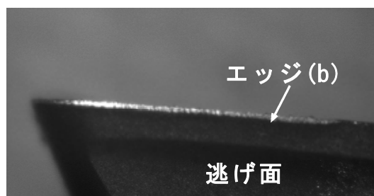
図12 オフラインにおける工具切刃の画像
