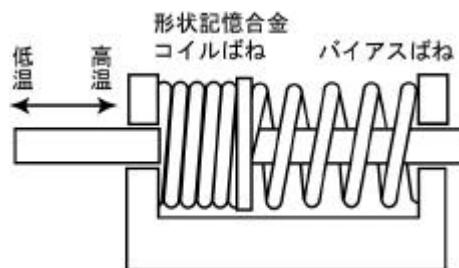
図 4.3.2-1 形状記憶合金コイルばねを用いた 2 方向性素子
