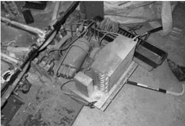
21 . 本体内部の下部から熱交換器とコンプレッサーを途中まで引き出す。(まだフロンを回収していないため、切り離さず)
