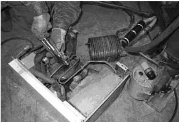
41. フロン回収のためピアッシングを挿す。
