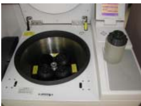
付写真 3 試料溶液の遠心分離
