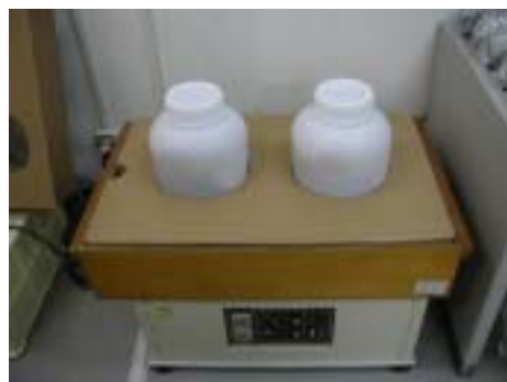
付写真 2 試料-塩酸(1+100)溶液の振とう
