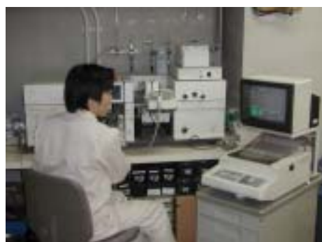
付写真 8 原子吸光分光分析装置による ろ液中の Na, K の定量
