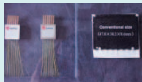
今回開発したMEMS-VOA Array（左、中）右の従来相当品の模型と比べるとかなり小型化されていることが分かる。コストは1/10。
