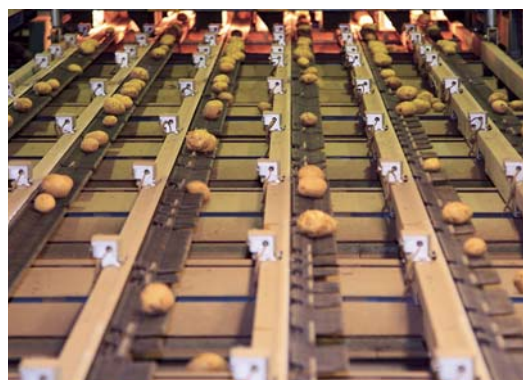
コンピュータ制御された最新の機械によって サイズ、等級別に分けられる
