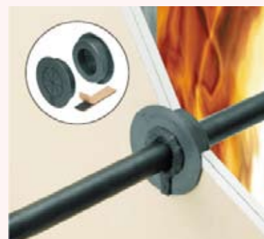
写真：社員発のアイデア製品「タイカブラック」 備考：「タイカブラック」：建築物の壁等において、ケーブルや配管の貫通部で使用 する防火部材。部材が熱を受けると膨 張し、延焼を防止する。
