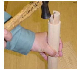
6. 芯棒を抜いて完成
