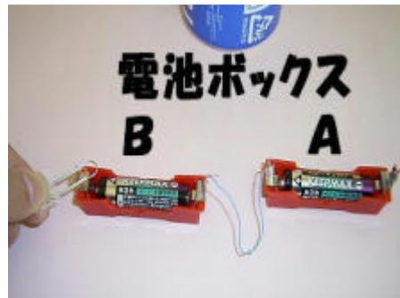
強弱を切り替えられるつなぎ方を工夫することにより、回路に流れる電流が強さが変化すると、モーターの回転も変化することを実感させることができる。
