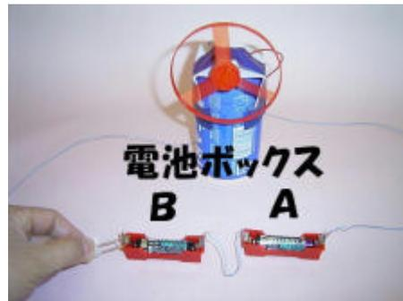
強風は、クリップを電池ボックスBの+極に接触させることで、乾電池2個の直列つなぎの回路となり、モーターが速く回る。
