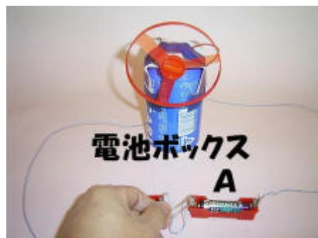
弱風は、クリップを電池ボックスAの+極に接触させることで、乾電池1個の回路となり、乾電池2個直列つなぎのときと比べ、モーターが遅く回る。
