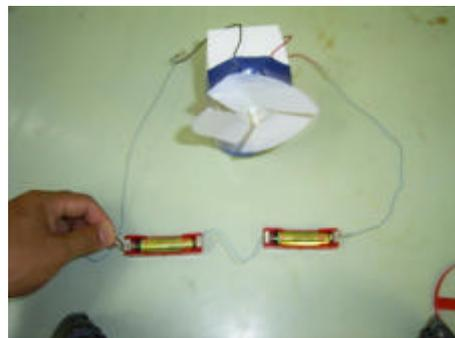
自作のプロペラを用いて、風が前面に向かって来るようにするためには電池を入れかえなければならない。このことで、電流の向きが変わるとモーターの回る向きが変わることを、実感させることができる。
