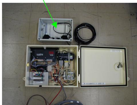
写真1 データ収集伝送装置 (全体)
