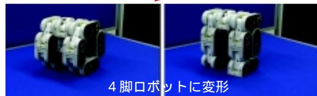
4脚ロボットに変形
