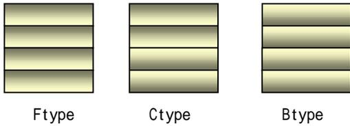
Fig.2 竹積層材の積層方法(重ね方の違いによるもの)
