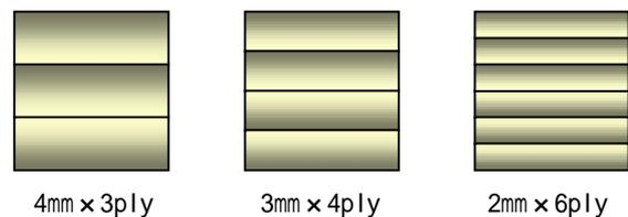
Fig.1 竹積層材の積層方法(厚さの違いによるもの)
