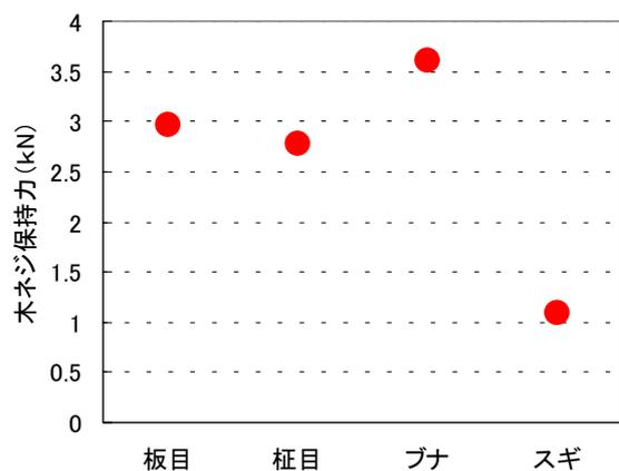
Fig.12 竹積層材の木ネジ保持力
