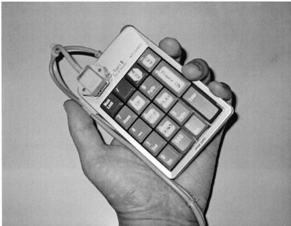
図7.方向指示によるボタン型リモコン
