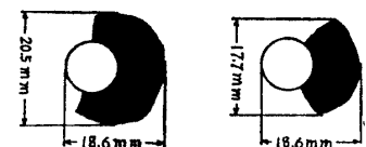
第 1.24 図 着氷の横断面の比較
