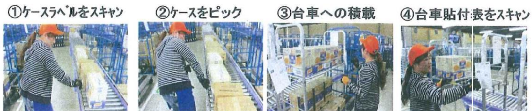
写真 3-2-11 シュート下での作業手順
