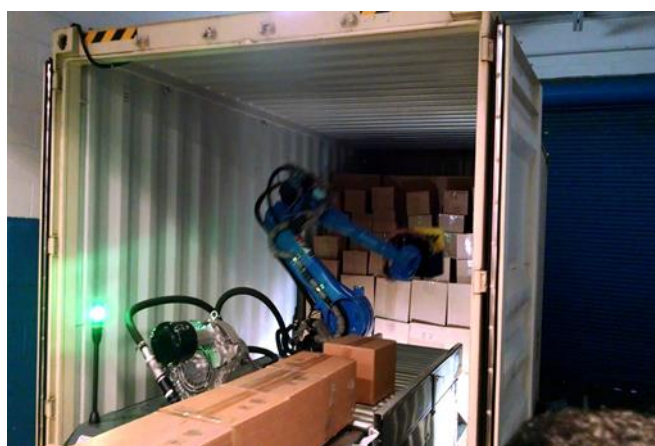
写真6-1-3 トラックコンテナから荷の積み降ろしを行うロボットの実証実験
