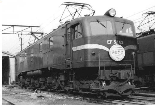
蒸気発生装置を搭載したEF58形電気機関車
