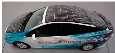
太陽電池パネルを搭載した「アリアスPHV」実証車 https://global.toyota.jp/newsroom/corporate/28781301.html
