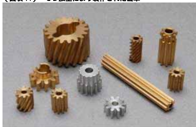
(図表14) CD加工により製作された歯車
