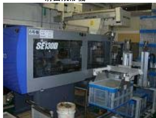
（図表 10）24 時間完全自動化を達成した射出成形機
