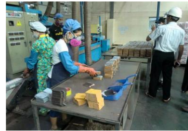
電極板をロット再セットするため先入れ先出しが崩れる
