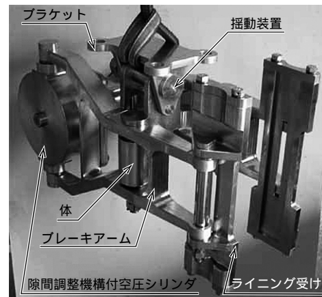
図1 開発した空圧キャリパ（2次試作）
