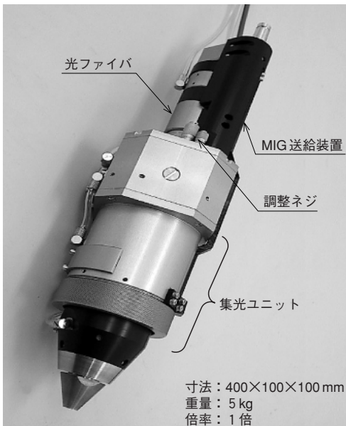
図4 MIG-YAGハイブリッド溶接ヘッド外観 ロボット駆動を想定し小型化を図ったヘッド外観。
