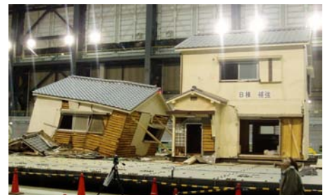
実大三次元震動破壊実験施設（E-ディフェンス）を用いた木造建物の震動破壊実験 写真提供：防災科学技術研究所
