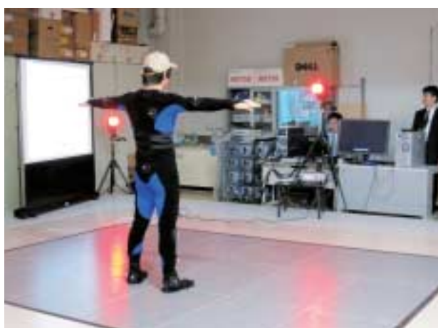
写真2 システム説明会でのデモの様子 (赤く光っているのが赤外線カメラ，被験者の足元の灰色の部分がフォースプレート)
