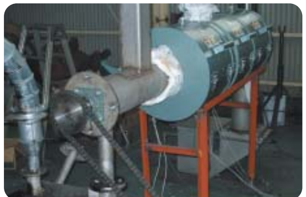
ステンレス鋼で作られた連続炭化装置
