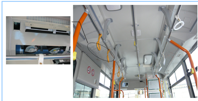
図2 エバポレータ搭載状況
