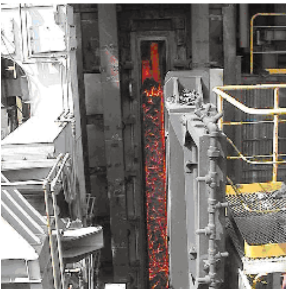
写真2 立上げ操業におけるコークス窯出し状況
