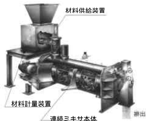
Fig.4 連続式ミキサ概念図
