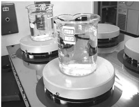
写真2 凝集沈殿ジャーテスト
