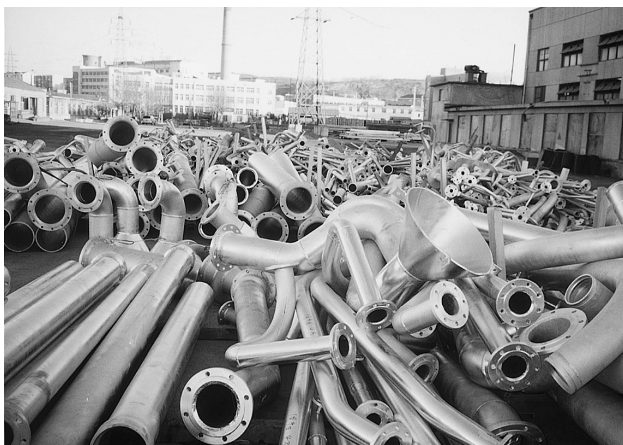
写真 3－2 大連金州熱鍍有限公司の溶融亜鉛メッキ処理製品
