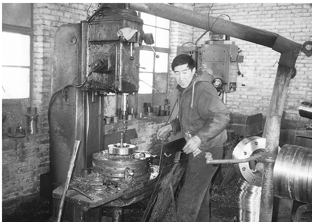
写真5-1 大連今冶金属機械有限公司のフランジ切削加工
